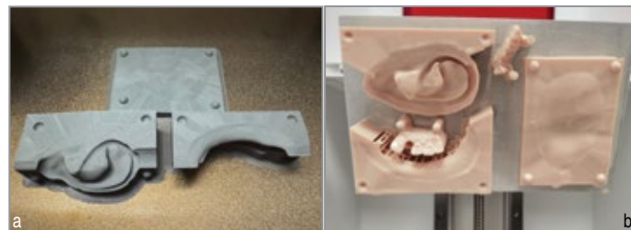
Figura 2. Tipare pentru confecționarea unei epiteze auriculare, obținute prin tehnologii diferite de imprimare 3D: a) FDM și b) SLA. Imaginile surprind tiparele imediat după procesul efectiv de printare, înaintea post-procesării necesare în cazul tehnologiei SLA.
