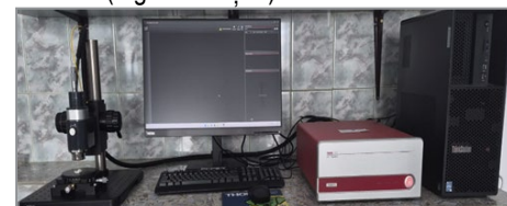
(a) Sistemul SD-OCT Telesto TEL221 utilizat pentru achiziția imaginilor.
