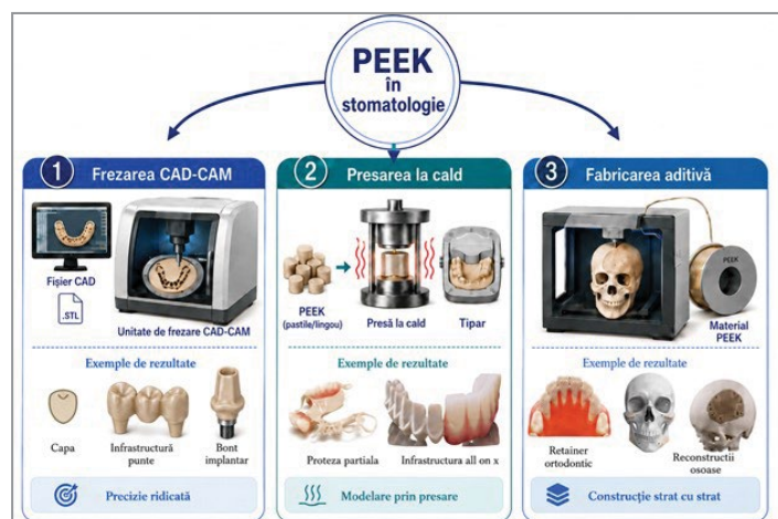
Figura 1. Tehnologiile de fabricare a componentelor din PEEK utilizate în stomatologie și protetica maxilo-facială.
